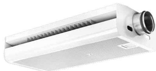
Der Raumregler ist werkseitig in die Frontplatte von NOVA II integriert und angeschlossen. Diese Konfiguration nutzt den Temperaturfühler, der in den Raumregler integriert ist. Der Kondensationsensor (optional) ist werkseitig angeschlossen
