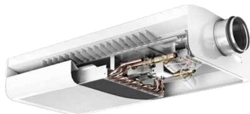
Der Raumregler ist werkseitig montiert und hinter der Frontplatte von NOVA II verborgen angeschlossen. Diese Konfiguration nutzt einen Außenlufttemperaturfühler, der unter dem Wärmetauscher installiert ist. Temperaturfühler und Kondensationssensor (optional) sind werkseitig angeschlossen.
